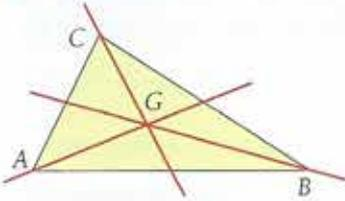
Las **medianas de un triángulo** son las rectas que se obtienen al unir cada uno de los vértices del triángulo con el punto medio del lado opuesto.
